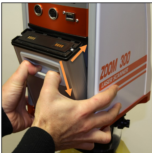
Рисунок 5: Установка аккумуляторов ZOOM 300
