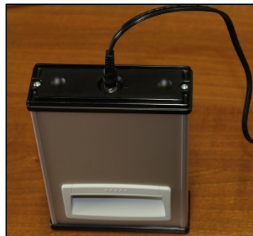
Рисунок 12 Присоединение разъема зарядного устройства
