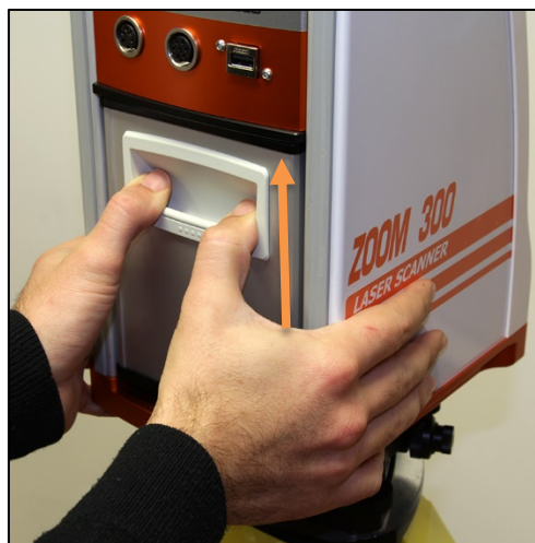
Рисунок 6: Установка аккумуляторов ZOOM 300
